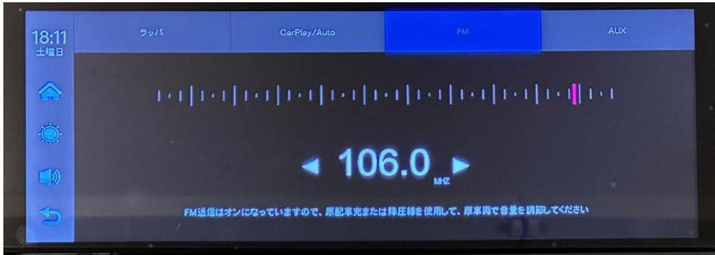
このモードを選択すると、音量アイコンがFM送信アイコンに変わります。このデバイスでは音量を調整できないため、元の車両で調整する必要があります。
