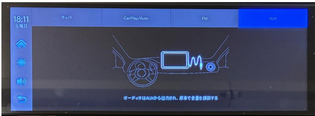
AUXを選択すると、AUX出力モードがデフォルトでオンになります。機器をAUX音源ケーブルで元の車両に接続します。接続が成功すると、機器のすべての音がAUX音源ケーブルを介して元の車両のスピーカーに送信され、再生されます。
